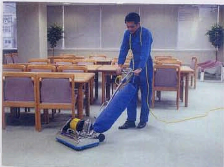
天然繊維のブラシで起毛、整毛しながら土砂を掻き上げます。
