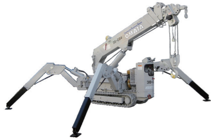
2.35t カニクレーン CR235GL とサーチャーフック (オプション)
